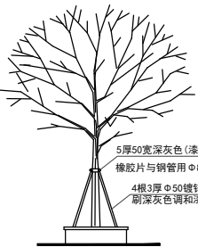
镀锌钢管护树架示意图
