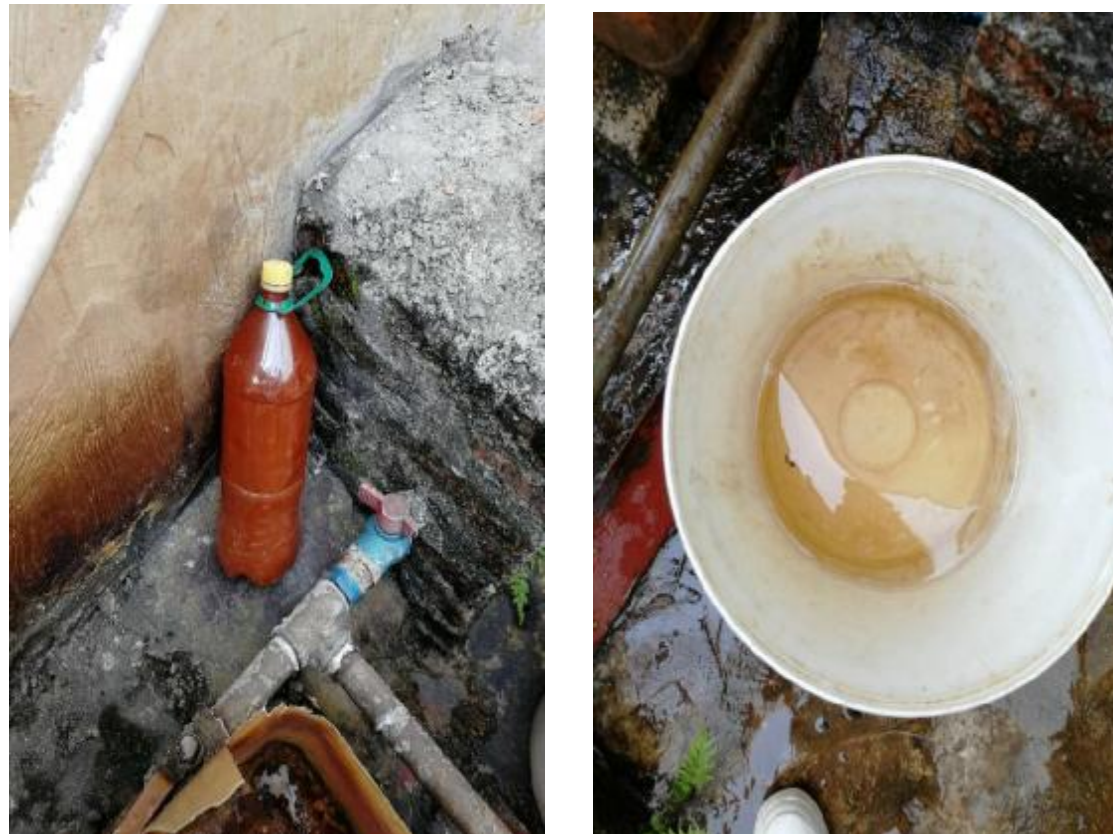
图 5-3-9-11 根竹园经济社地下水水质（部分呈发黄状）
