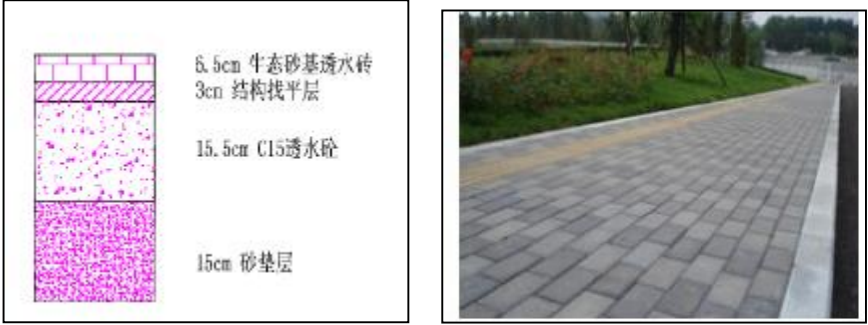
图5-10-1 人行道透水铺装结构图和意向图
