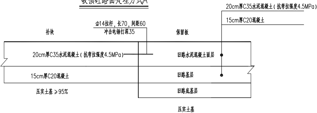
破损砼路面处理方式A
