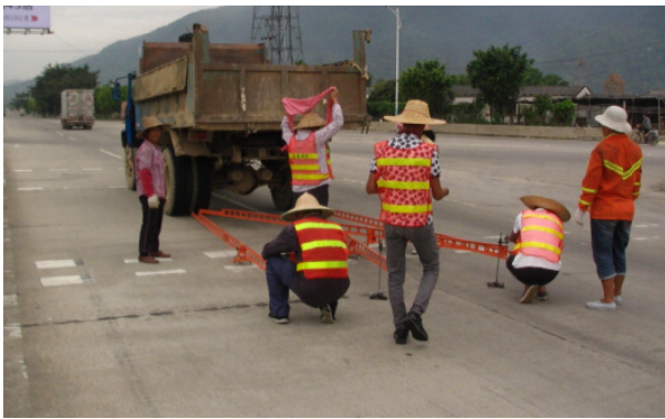
图 4-3 接缝传荷能力弯沉检测现场
