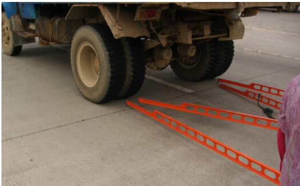
图 4-4 贝克曼梁在受荷板与未受荷板上的布设
