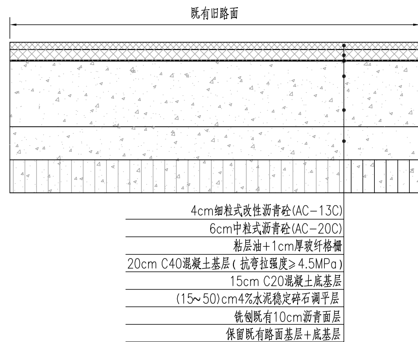
旧路改造段新建复合路面设计图 50 \leq H \leq 100\text{cm}
