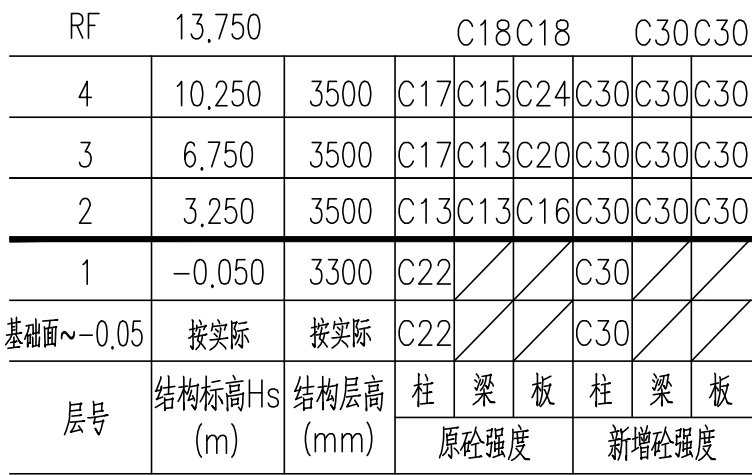
结构层楼面标高、柱梁板砼强度等级
