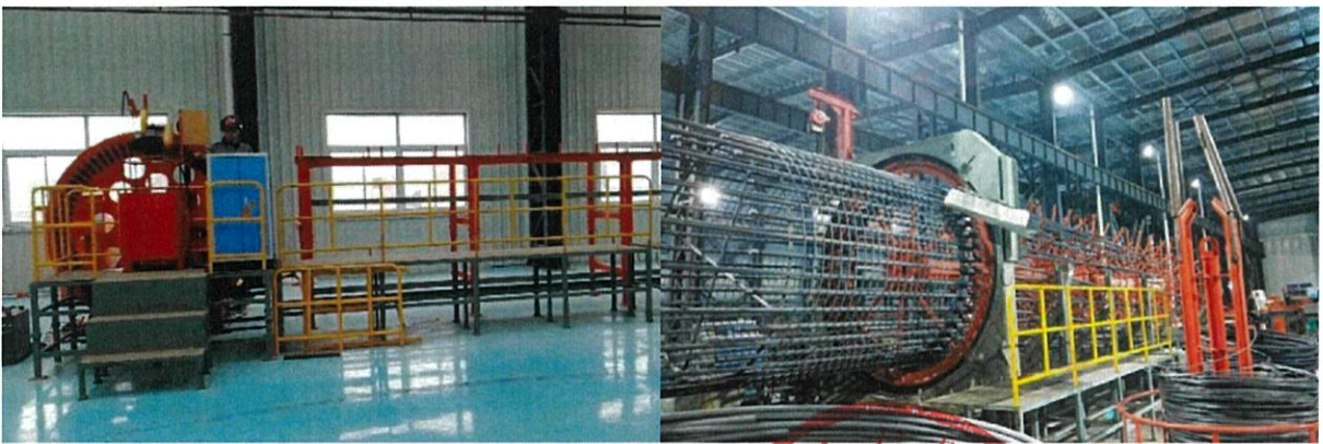
图 2.3.3-3 钢筋自动焊接弯圆机
