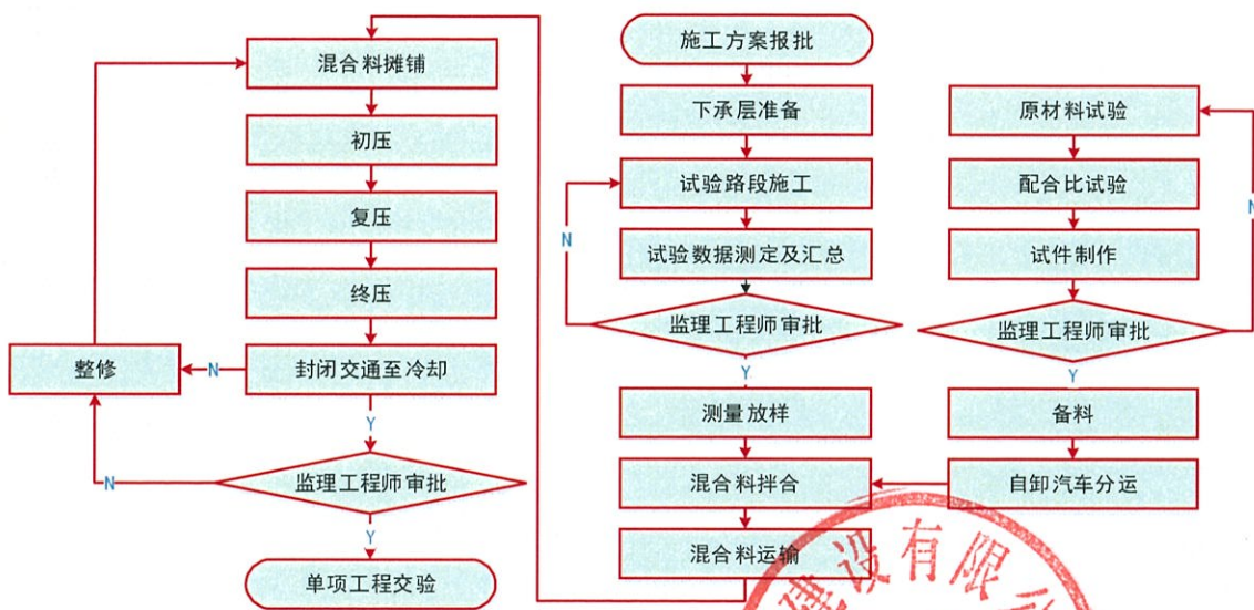
图 2.2.2-11 沥青面层施工工艺流程
