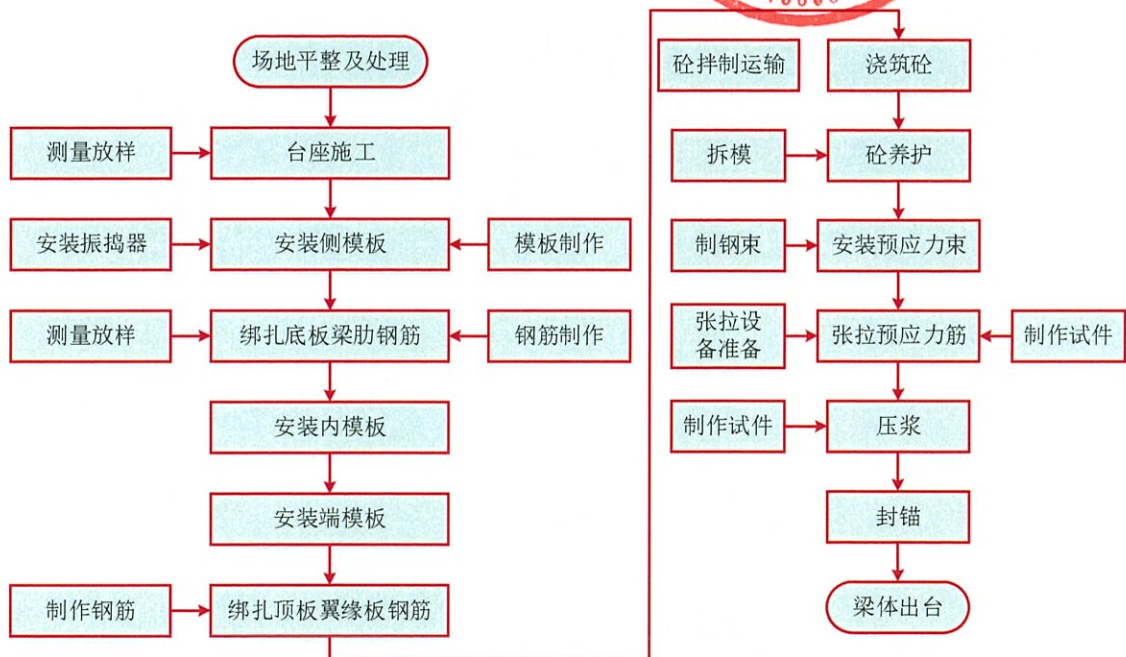
图 2.3.3-16 预制梁预制施工流程图
