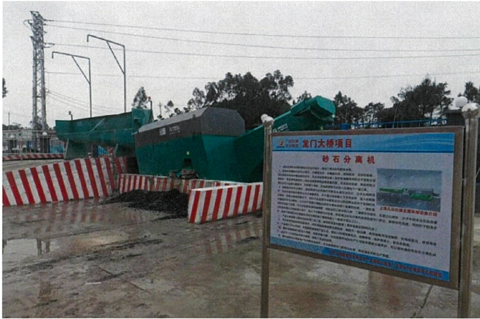
图 1.4.2-21 砂石分离机处理系统
