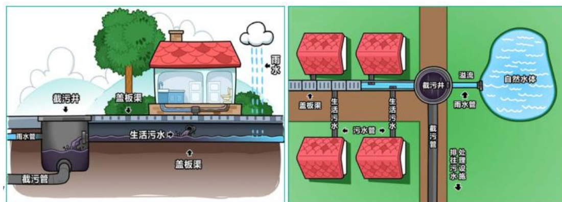
图 5-4 盖板渠和截污管收集方式
