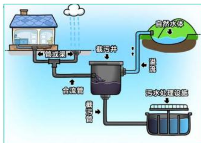
图 5-1 截流式合流制排水体制
