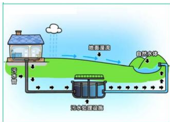
图 5-3 污水管和地面漫流排水体制
