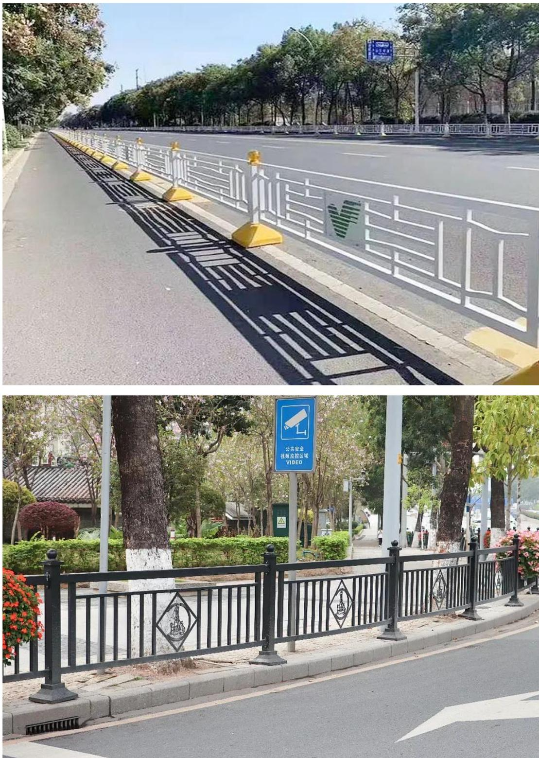
图 6.2.3-5 人行道及非机动车道护栏样图
