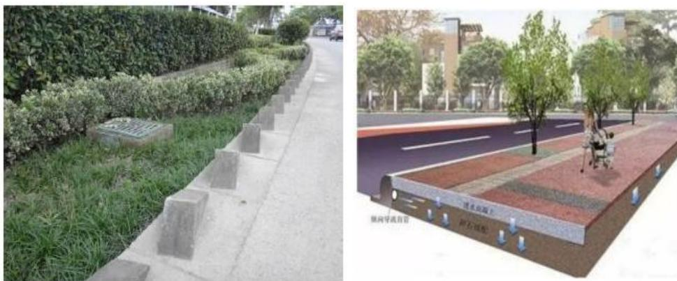
图 7.6-6 雨水口海绵城市实景与示意图
