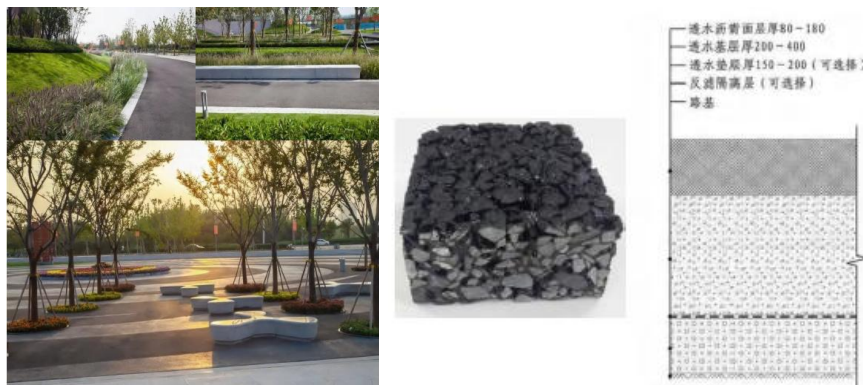
图 8.6-3 沥青透水路面示意图
