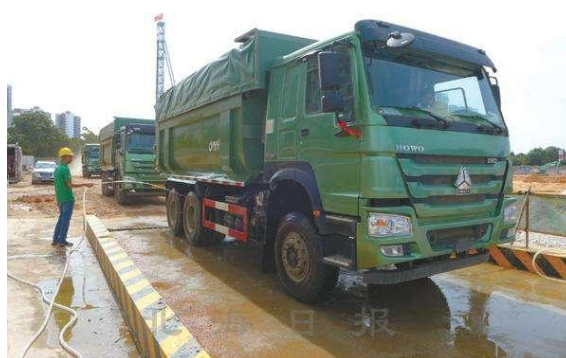
泥头车冲洗、遮盖、限载示例图
