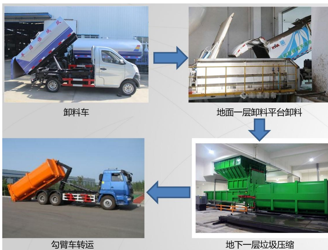
图 5-15 生活垃圾压缩工艺节点参考图
