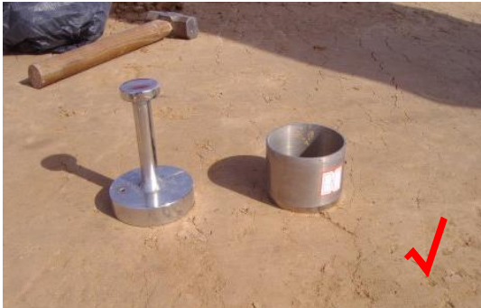
5. 环刀取样测压实度
