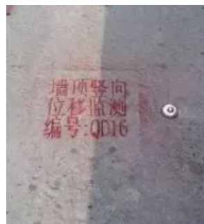
边坡顶部竖向位移监测
