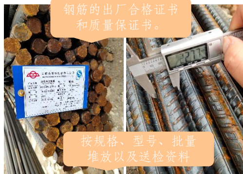
1.钢筋、焊条原材进场验收、送检
