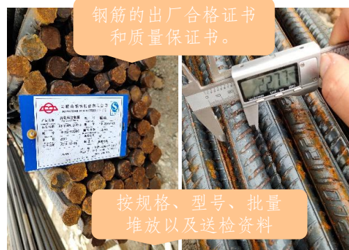
1.钢筋、焊条原材进场验收、送检
