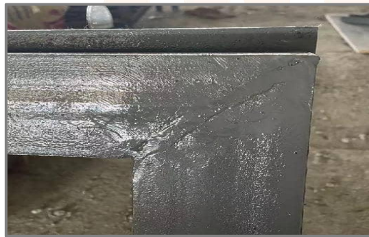
2. 支、吊架焊接打磨平整后再刷漆。
