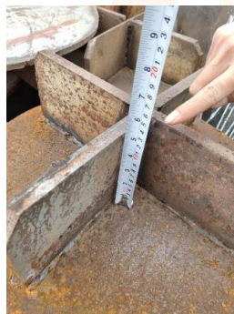
2. 桩尖进场检查。结构、规格、质量
