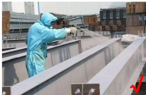
3.在工厂喷涂完成防锈漆及面漆。
