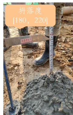
4. 混凝土坍落度检验、浇筑混凝土。
