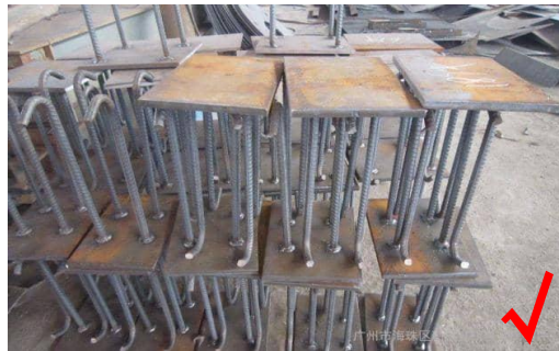
1.预埋件尺寸，弯勾符合设计要求。
