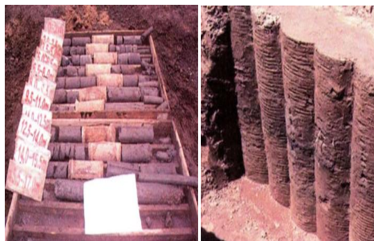
5. 钻芯、开挖检查成墙质量
