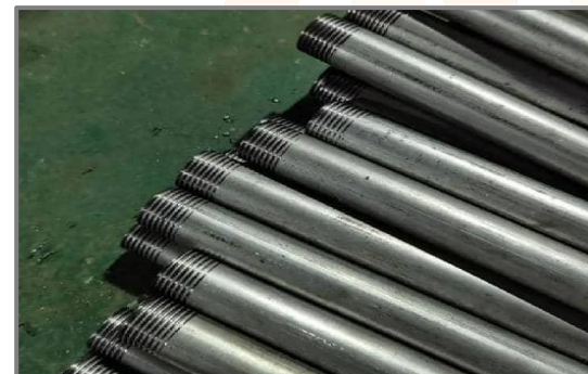
2.螺纹连接的管道套丝均匀。
