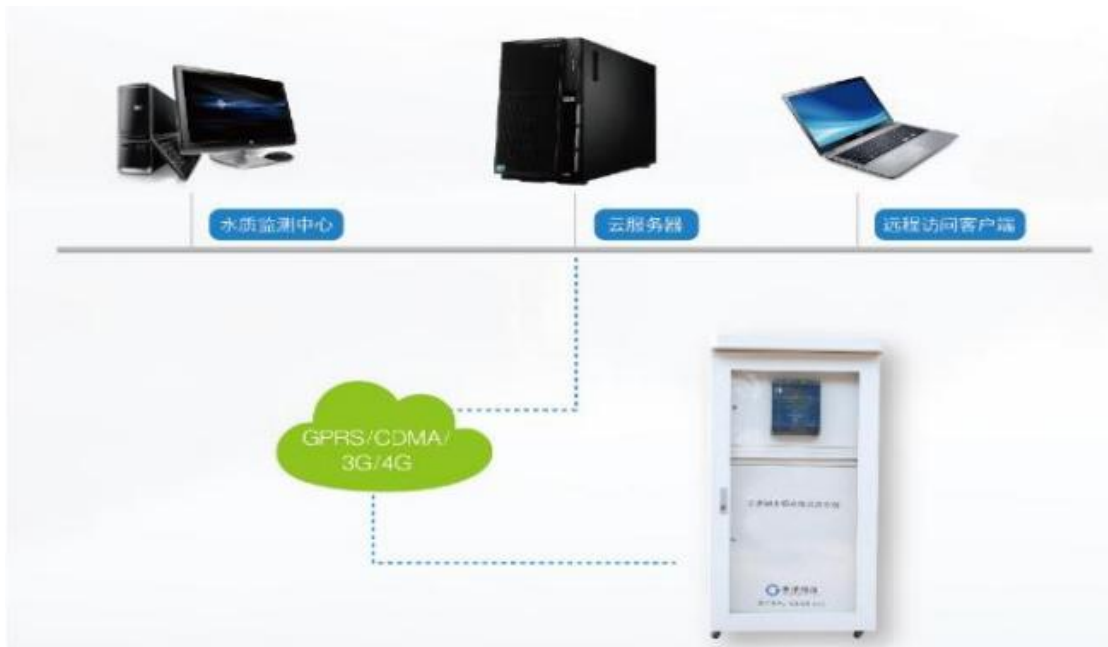
图 5-12 水质在线检测系统图
