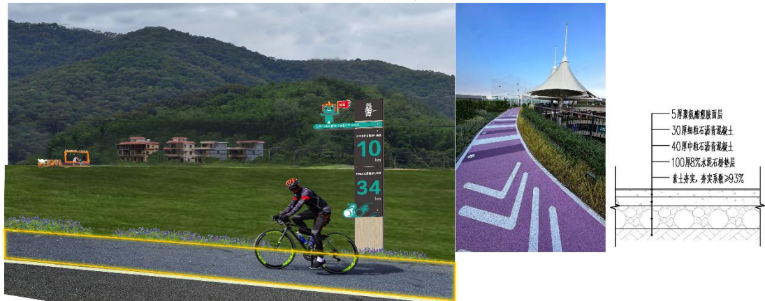
图 5.4.1-3 骑行道构造意向及大样图
