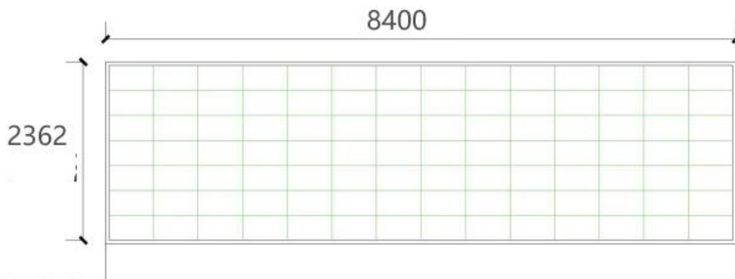
中控室主显示屏幕尺寸图
