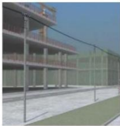
电缆线沿电杆敷设示意图
