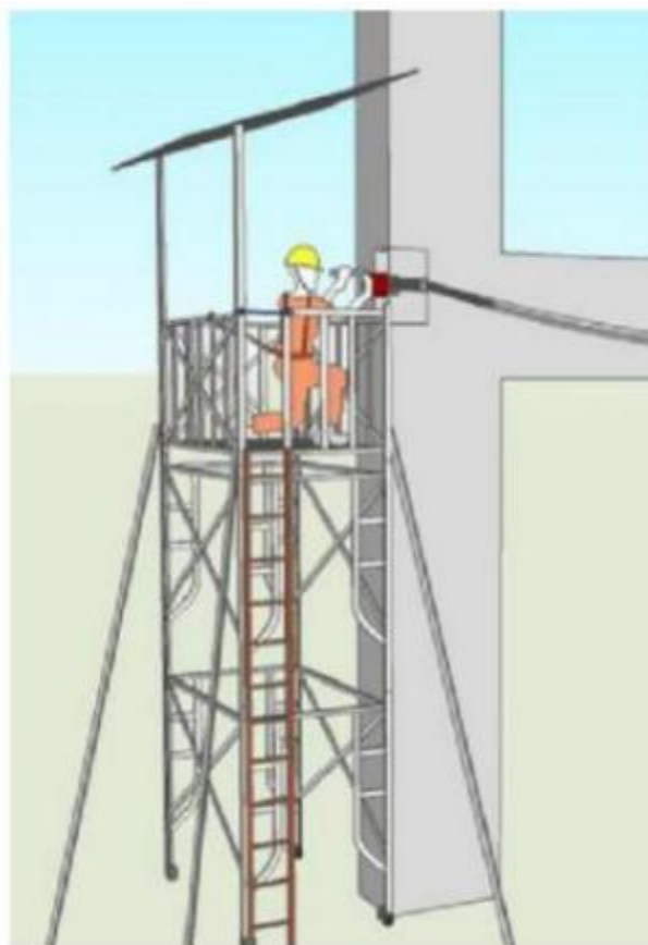
预应力混凝土张拉悬空作业安全防护示意图
