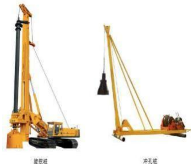
桩基施工机械
