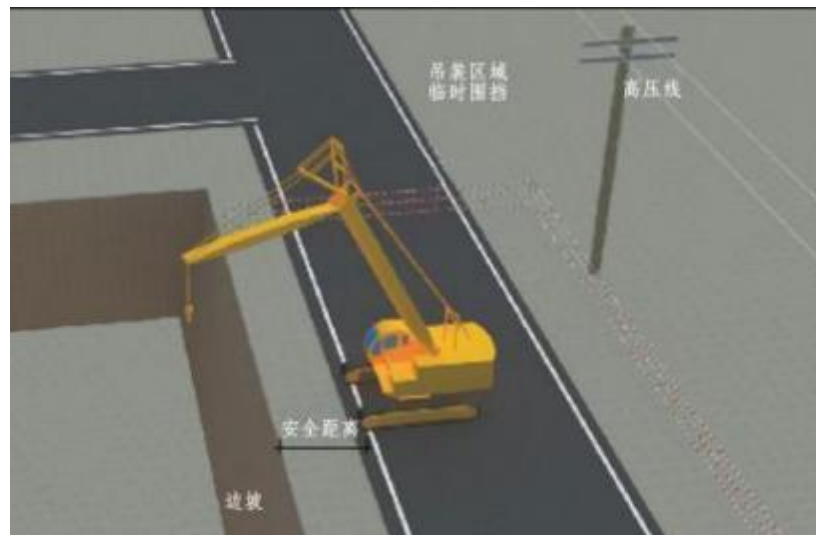
履带式起重机吊装示意图
