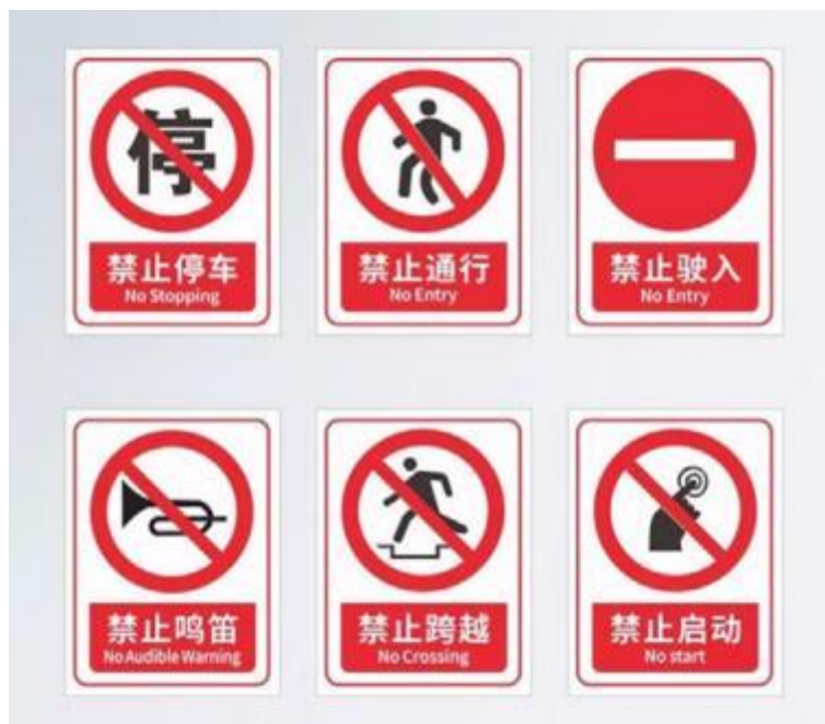
施工区常用禁止标志示意图
