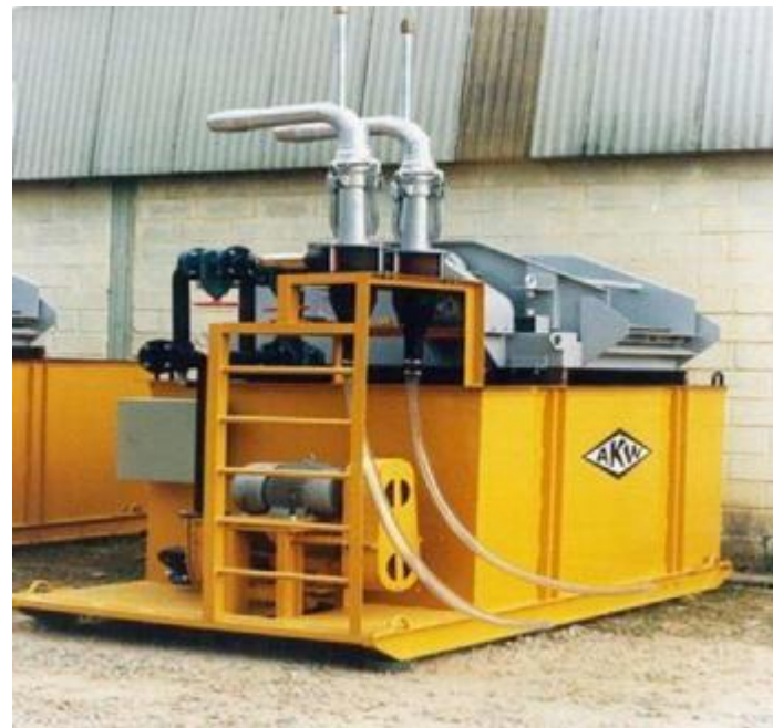
三级沉淀池脱泥设备
