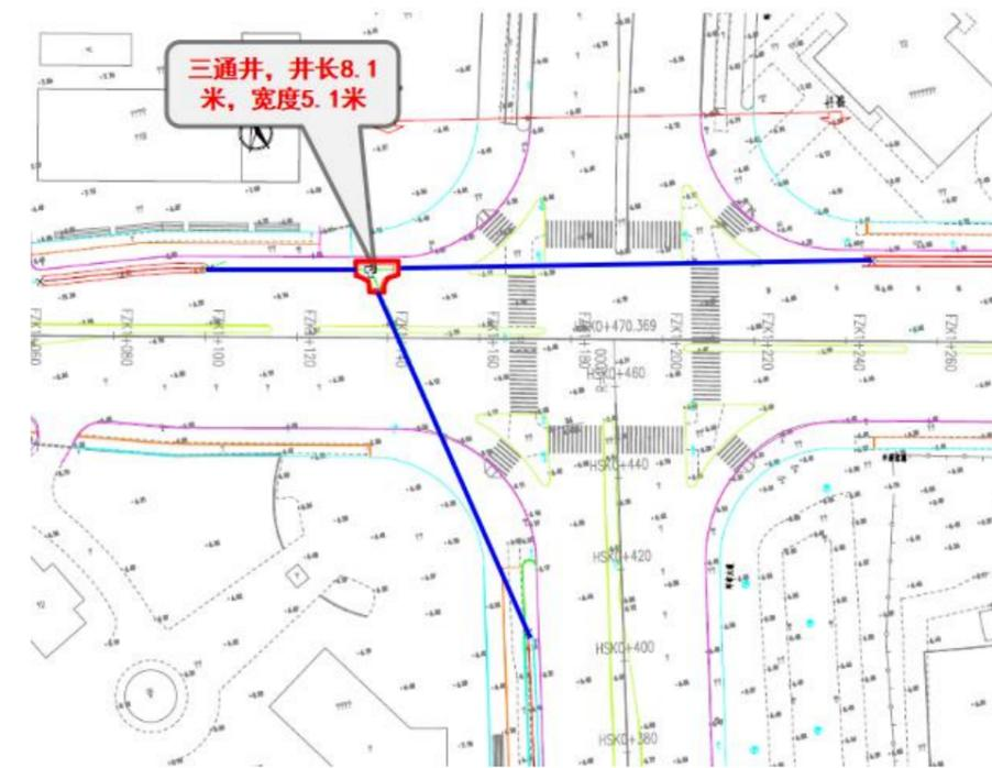
图 5.3.28 丰泽东路与环市大道工作井平面图（方案二）
