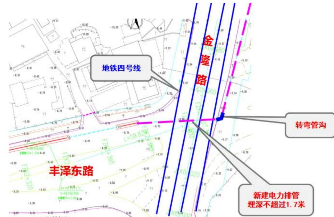
图 5.3.26 上穿地铁四号线平面图
