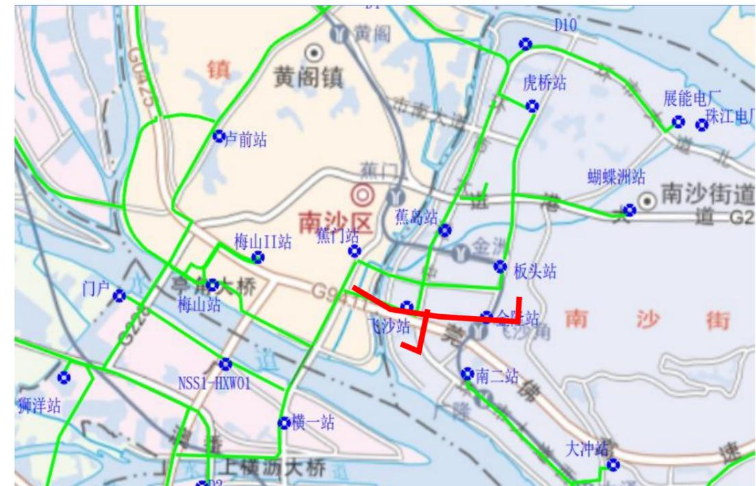
图 2.3.3 板头变电站配套电力管廊近期建设电力管廊线位
