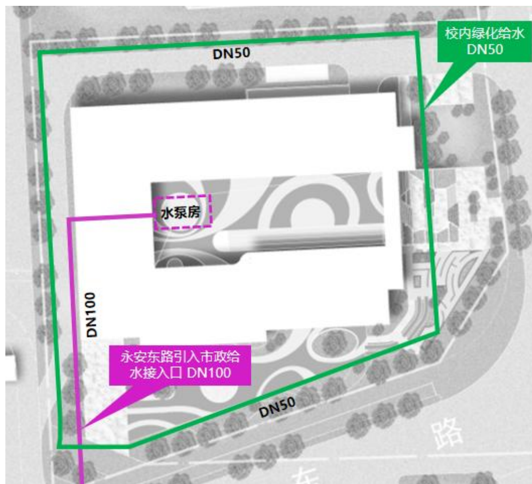
图 5.2.1-26 幼儿园给水工程平面示意图
