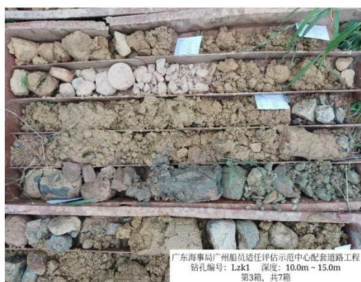
图 6 填土钻探取芯
