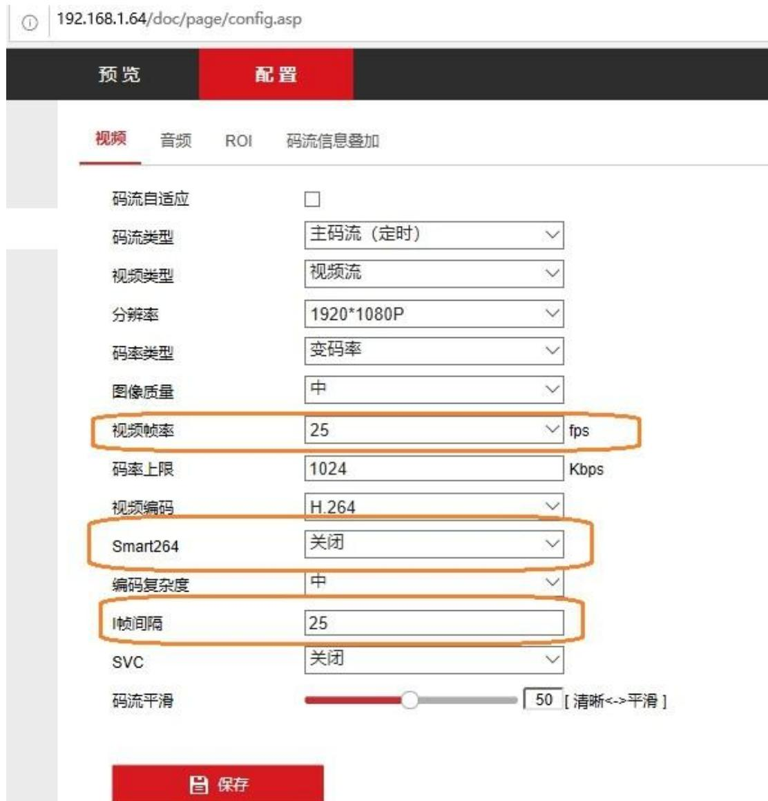
图 2: 摄像机音视频配置界面
