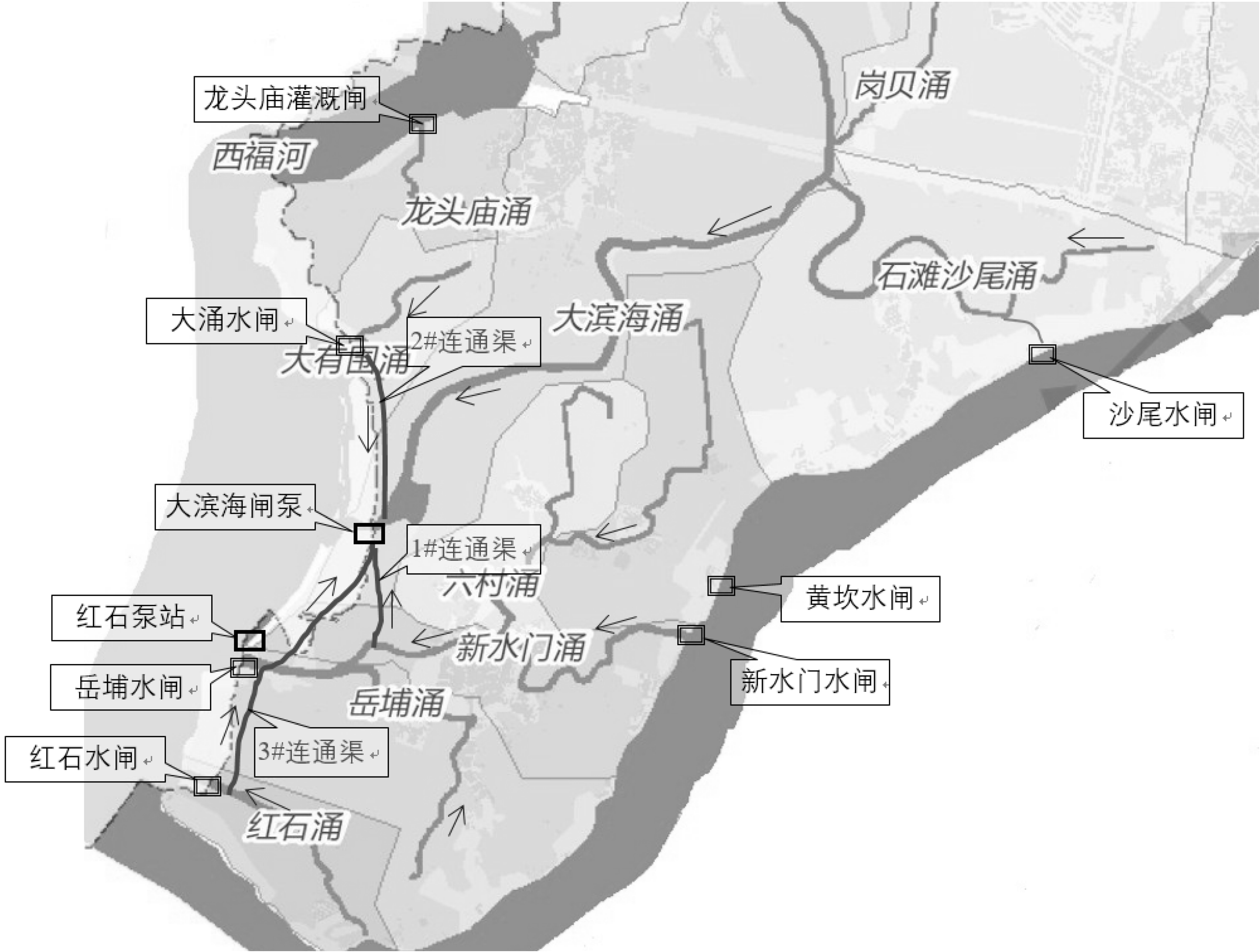
穿堤建筑物导流排水方案示意图
