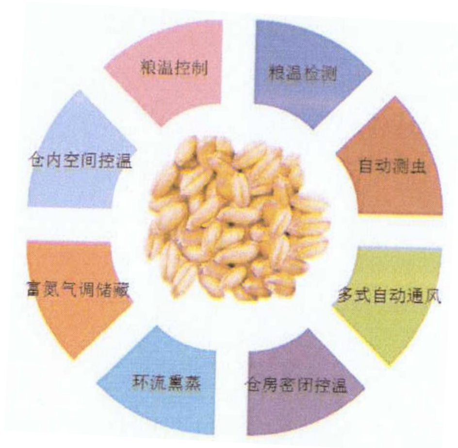
图 4-2 综合储粮系统
