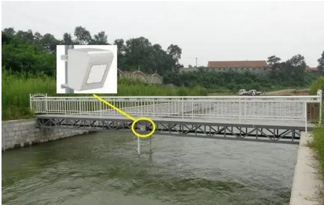
图 7.7.2 流量监测设备示意图
