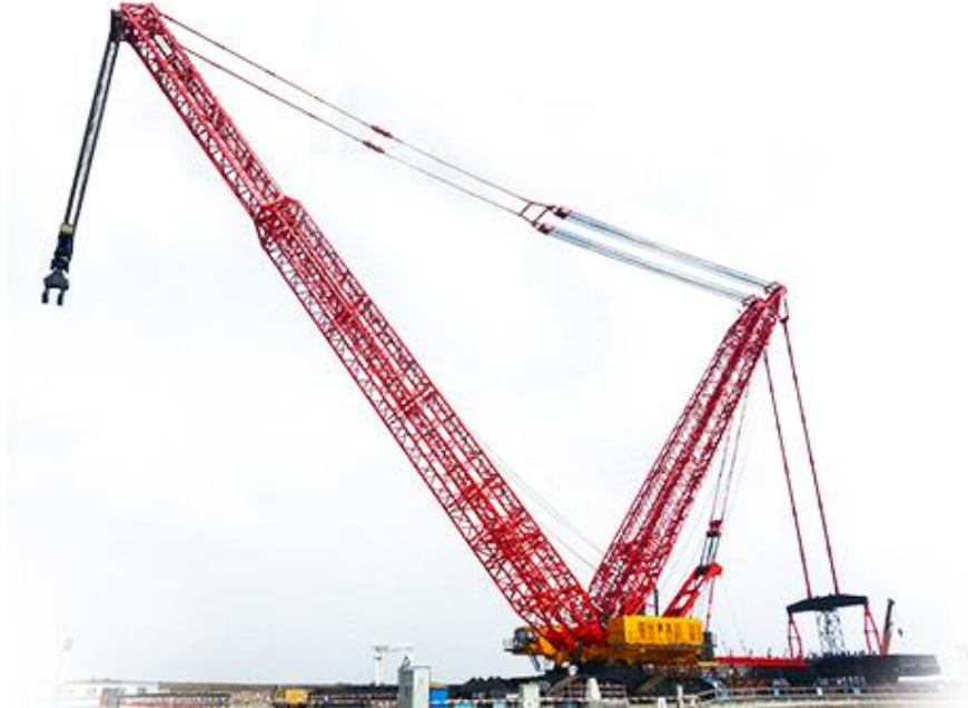
图 7.3.35 SCC3200A（350T）履带式起重机
