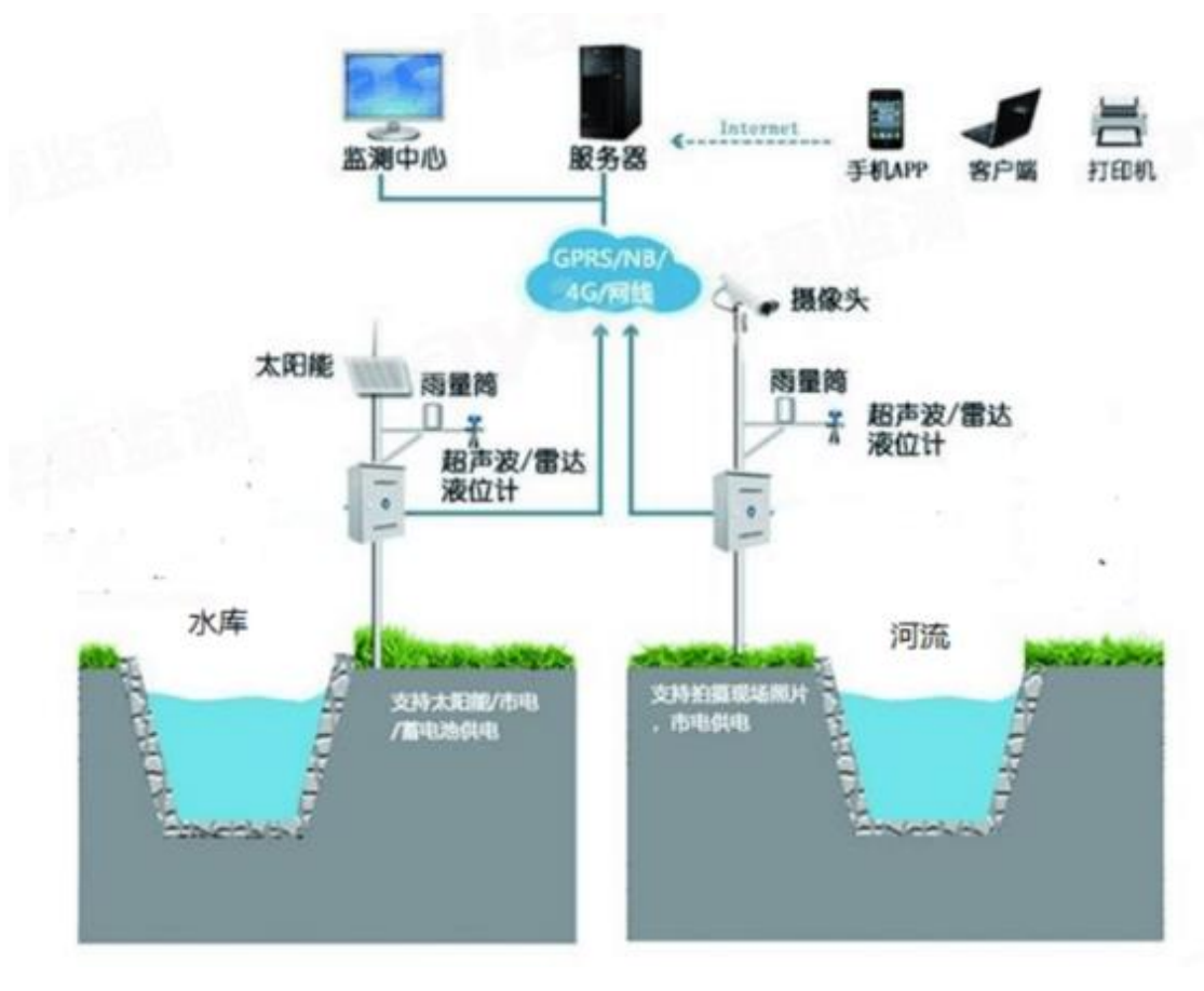
图 7.7.1 水位（降水）观测设备示意图
