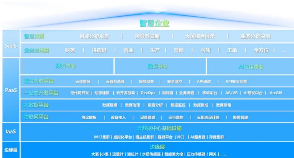
边缘层主要是智能水表、流量计、液位仪、水质传感器、智能消防栓、压力传感器等生产现场数据采集设备，是公司数字化应用和底层物理设备的桥梁，主要负责对接不同厂商、不同协议设备，开展从物理层到中台层和应用层的数据采集与传输、异构设备协议解析与转换，以及多元数据分析与处理，降低网络传输负载和云端计算压力。
