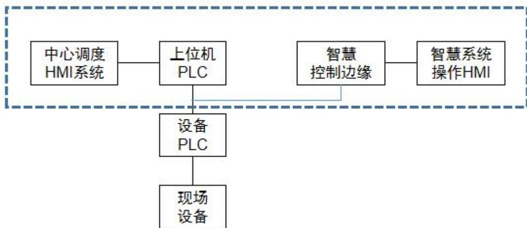
综上所述，水厂设备控制分五层实现，即运行管理调度层（智慧控制层）、中央控制层、主控 PLC 自动控制层、现场软手动（HMI）控制层和就地手动控制层。控制等级由高到低依次为：就地手动控制层、现场软手动（HMI）控制层、主控 PLC 自动控制层、中央控制层、运行管理调度层（智慧控制层）。对应主要设备控制模式分为三种：就地控制方式（其中现场软手动（HMI）控制层在自动控制方式中现场人机界面上实现）、远程控制方式、停机。
