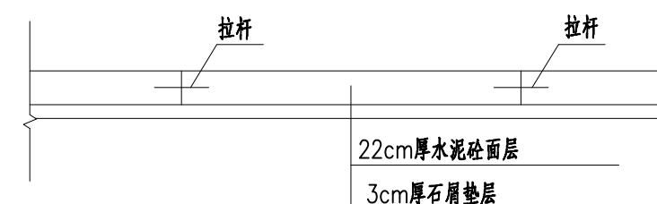
A-A断面路面挖除后新铺结构图(一)
