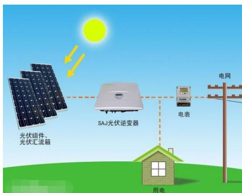
图 5.1-15 光伏发电系统示意图
