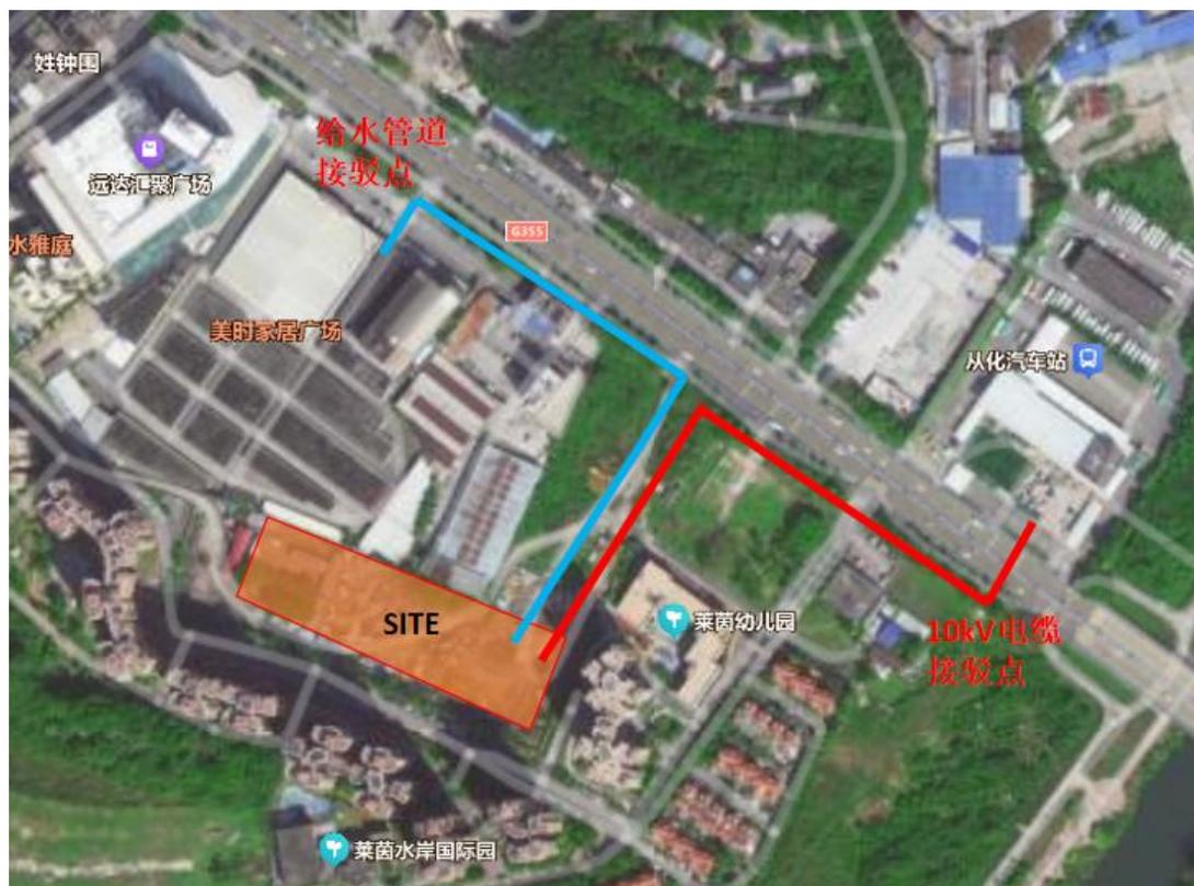
图 4.4-1 地块周边 10kV 电缆和市政给水管可接驳情况
