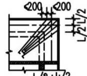
图三(b) 有肋挑板角部放射筋
