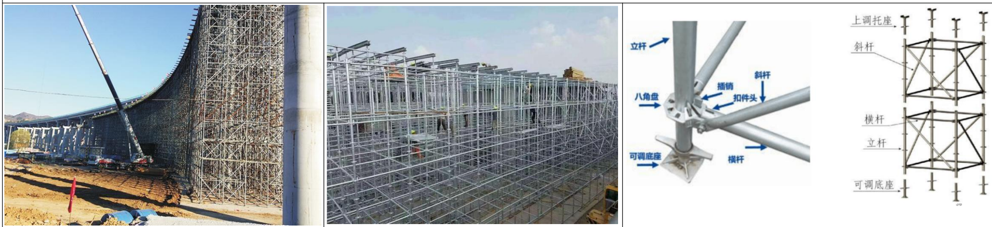
盘扣式支撑体系示意图
