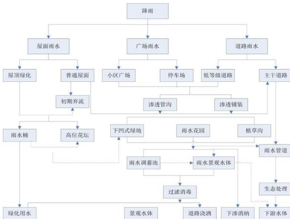
图 5-5 建筑与小区海绵措施衔接关系图
