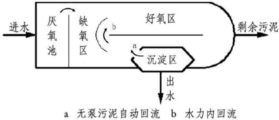
图 5-7 一体化氧化沟工艺流程图
