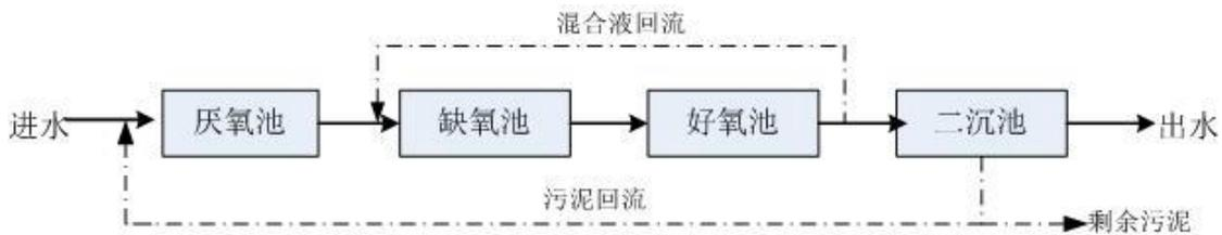
图 5-6 A<sup>2</sup>/O 工艺流程简图
