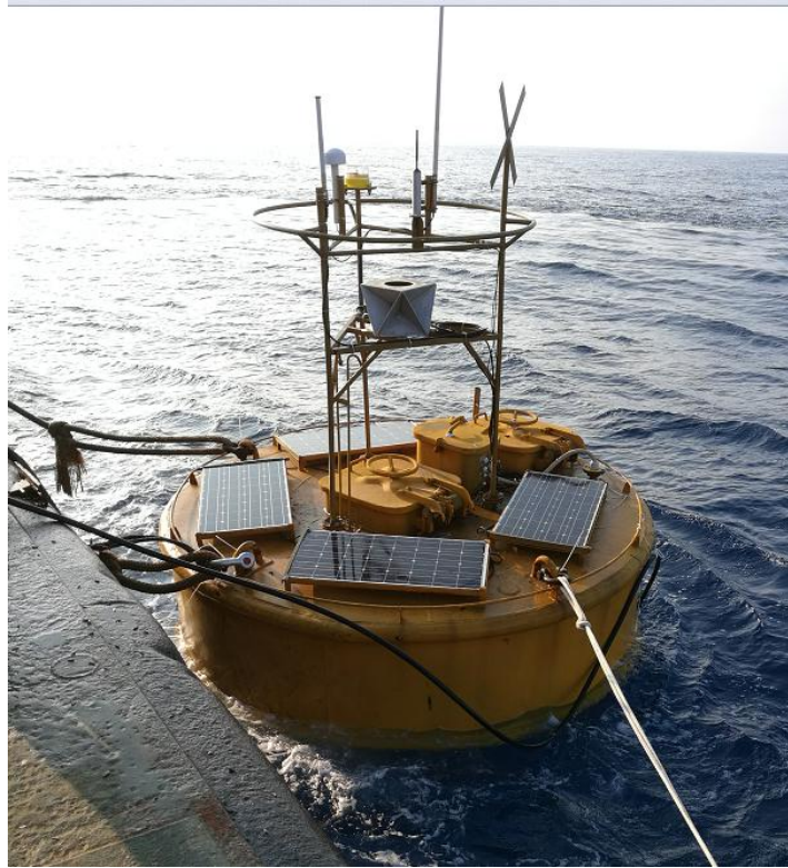
图 7.4 监测浮标示意图
