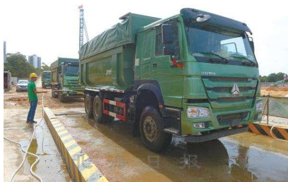
泥头车冲洗、遮盖、限载示例图
