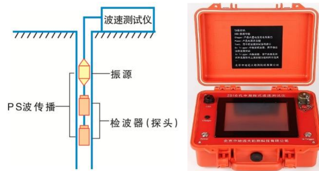
图 1 单孔法(孔中激振法)波速测试现场示意图
