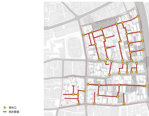
图 5.3-43 雨污分流系统分布示意图
