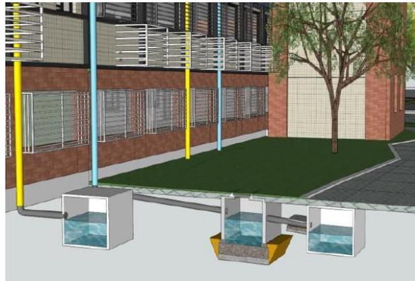
图 5.4-29 雨污分流工程意向图
