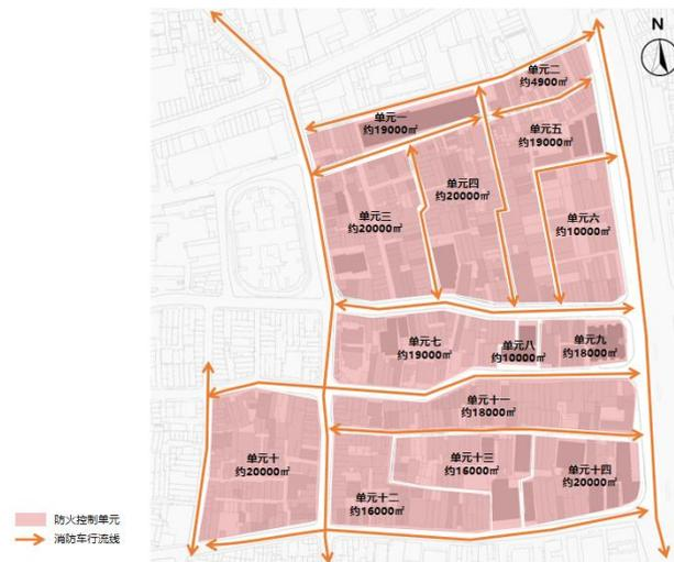
图 5.3-52 防火控制区规划图
