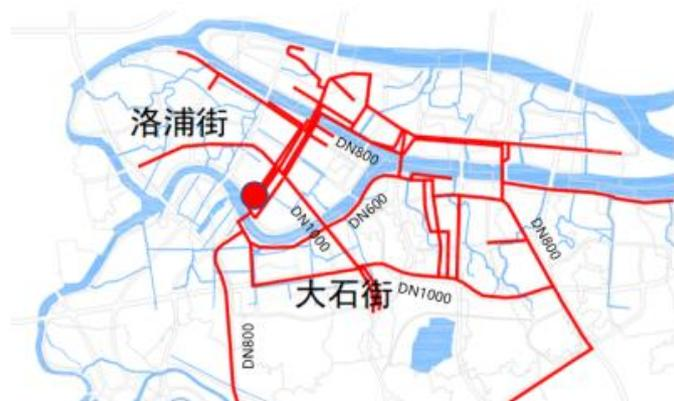
图 4.2-14 东乡水厂现状供水管网图
