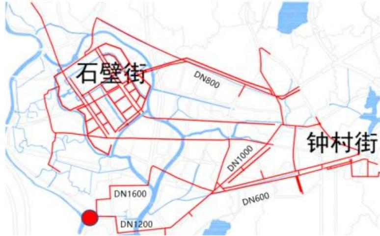
图 4.2-15 钟村水厂现状供水管网图
