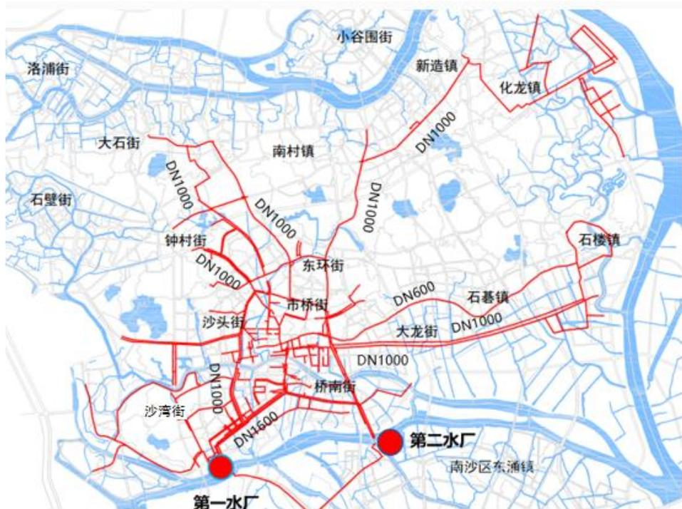
图 4.2-13 第一、第二水厂现状供水管网图
