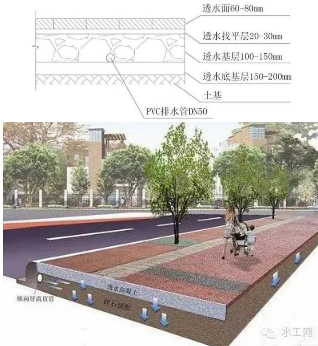
图 5.12-1 透水砖铺装典型结构示意图
