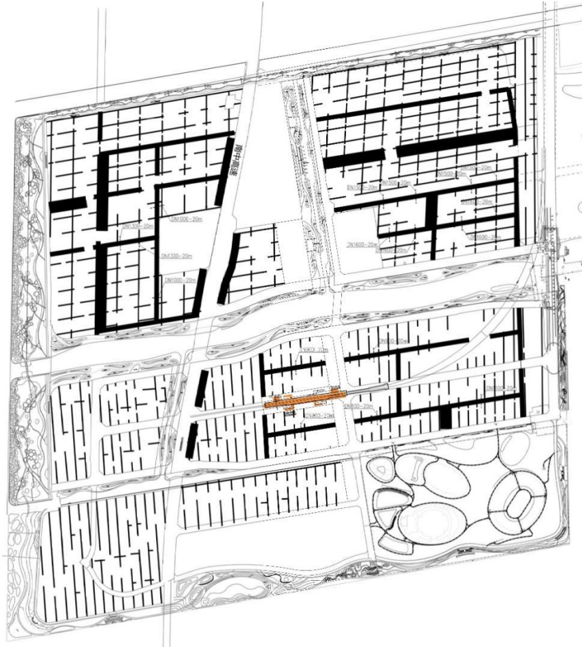
连通管布置平面图
