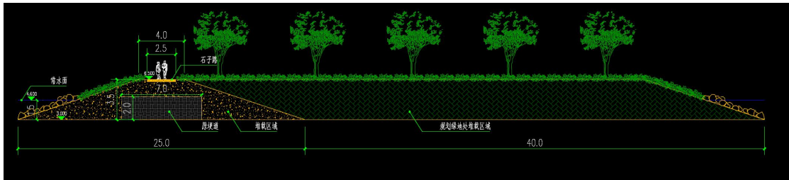
结合规划绿地区域生态覆绿堆载断面示意图
