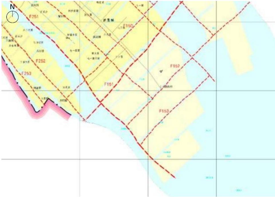
工作区周边区域断裂构造图
