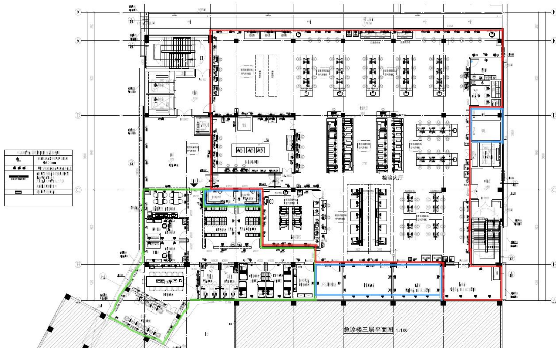
图 5-3-4 三层（检验科）平面图（分区示意：绿色代表清洁区，红色代表污染区，蓝色代表半污染区）
