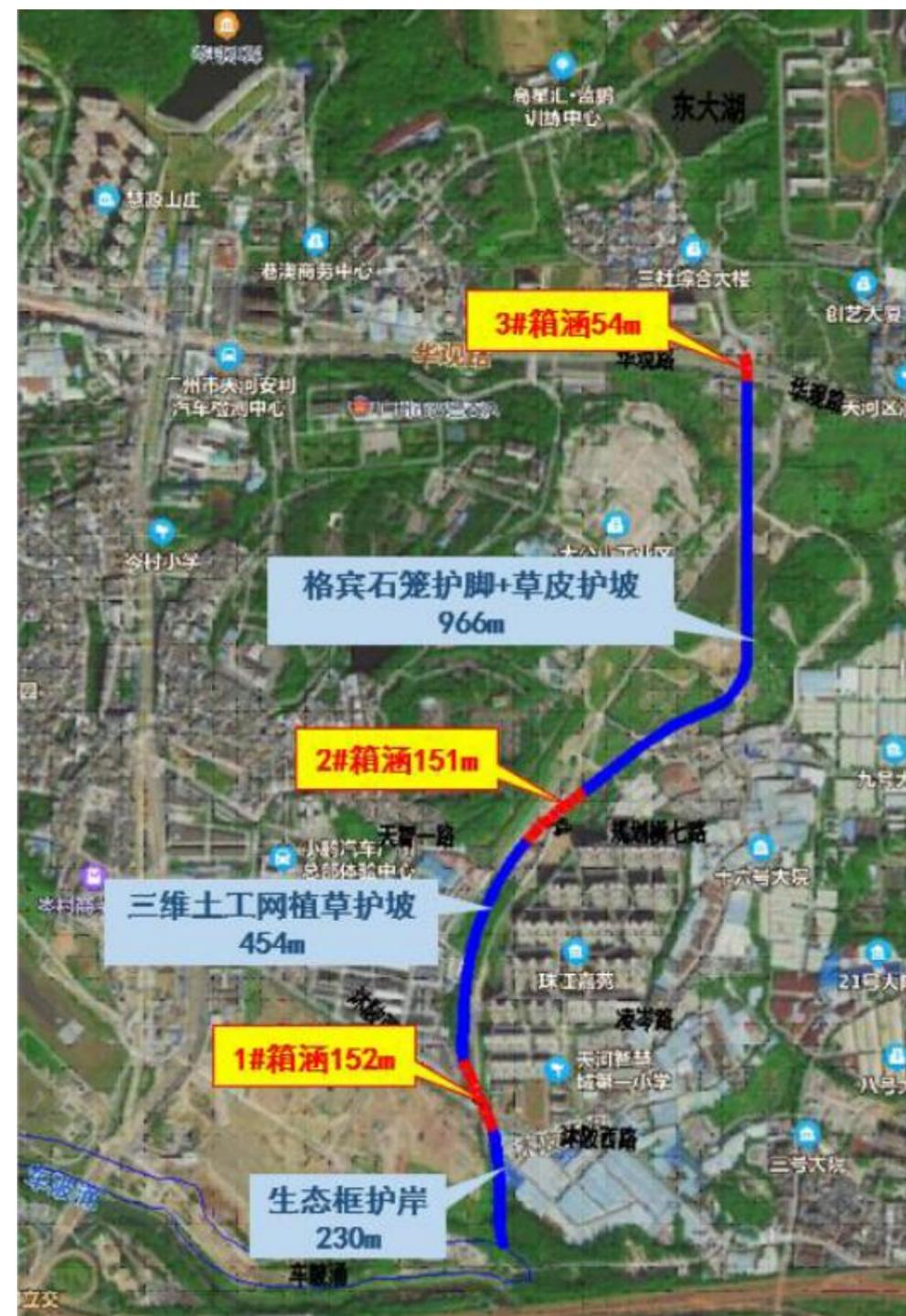
图：凤庄涌综合整治工程（华观路下游段）总布置图
