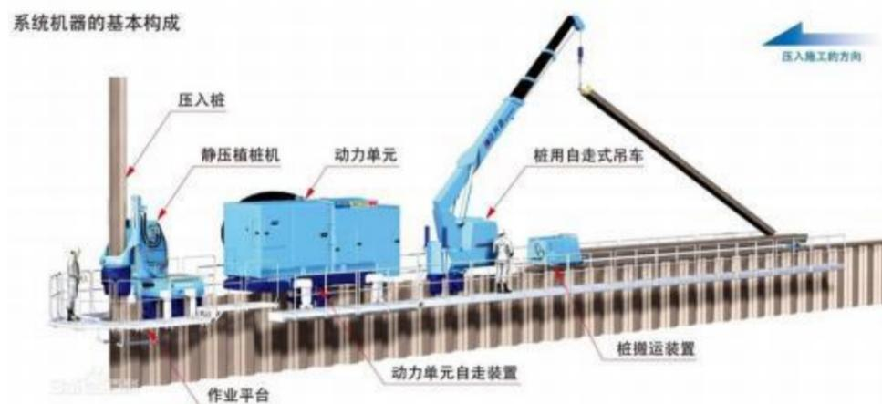
图：静压植桩机施工
