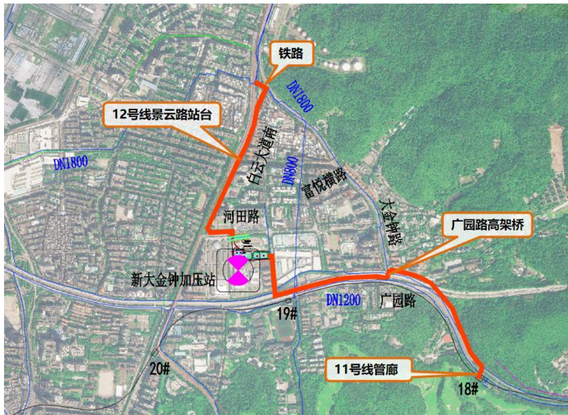
图 8.4.3 泵站进出水主管路由示意图
