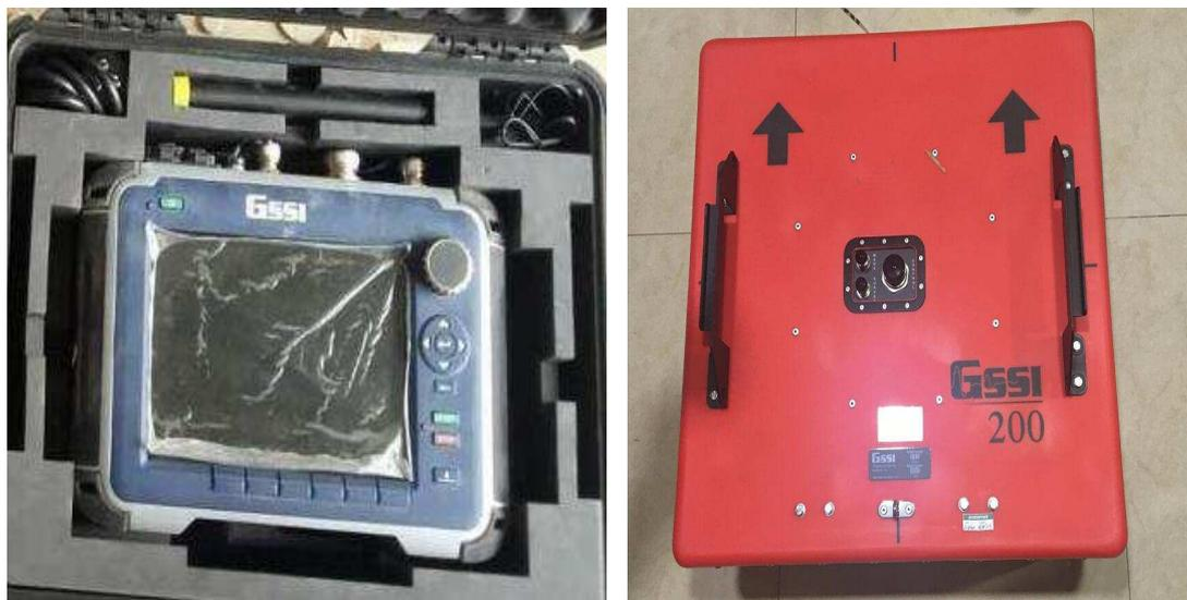
图 2 SIR-4000 探地雷达主机及 200M 天线
