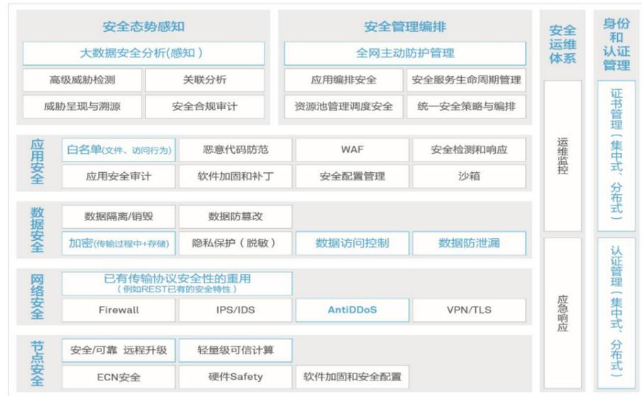
图 7.10.10 网络信息安全防护系统示意图
