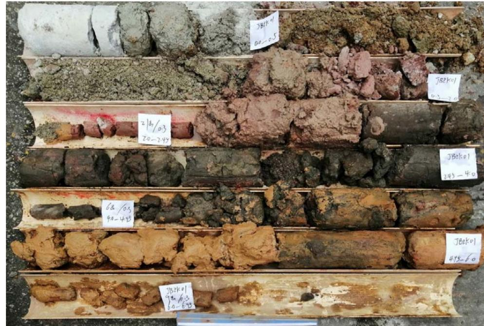
石北围排涝片区管网完善工程岩芯照片
