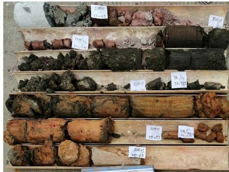
石北围排涝片区管网完善工程岩芯照片
