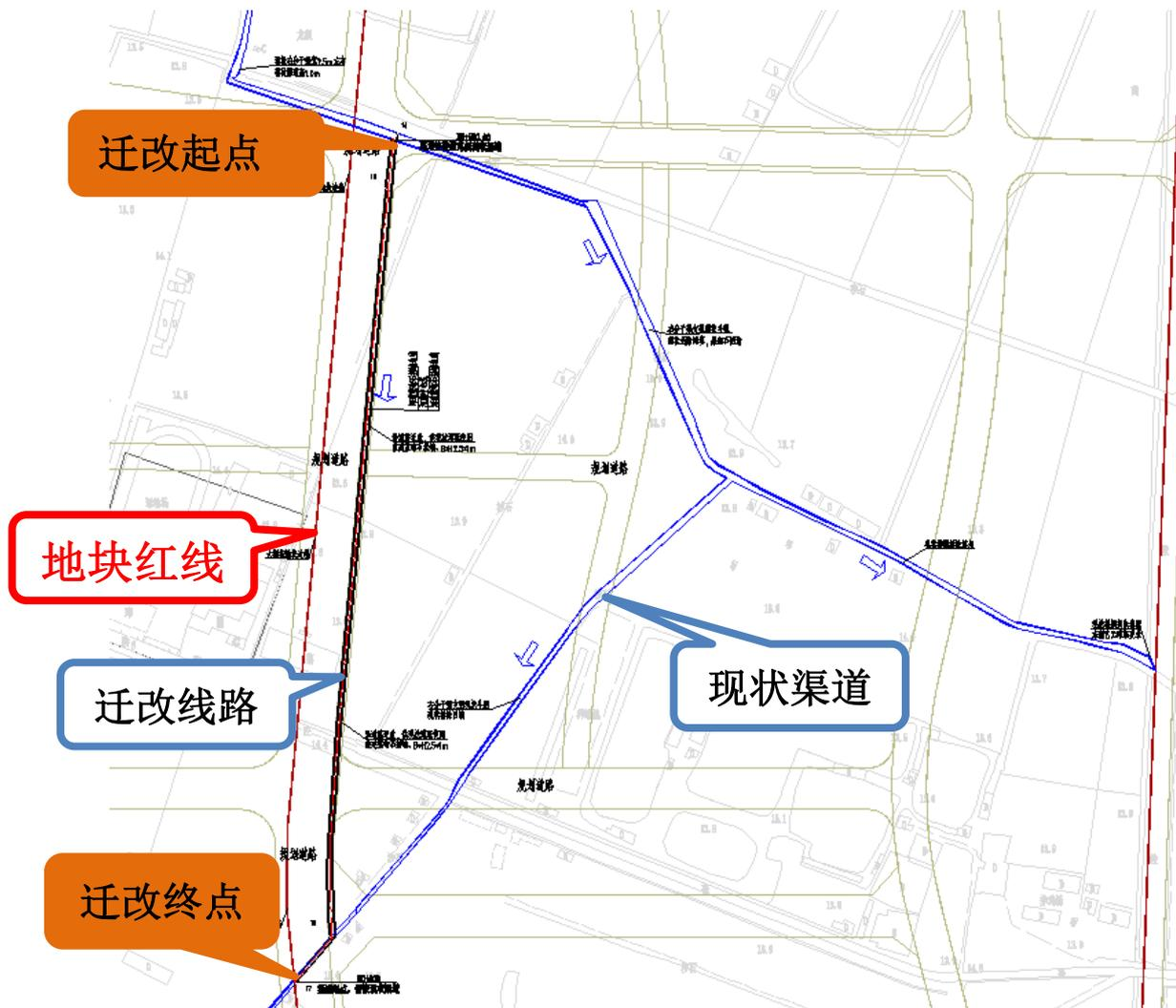
图 6.5-4 南侧右分干渠支渠斗渠改道平面示意图
