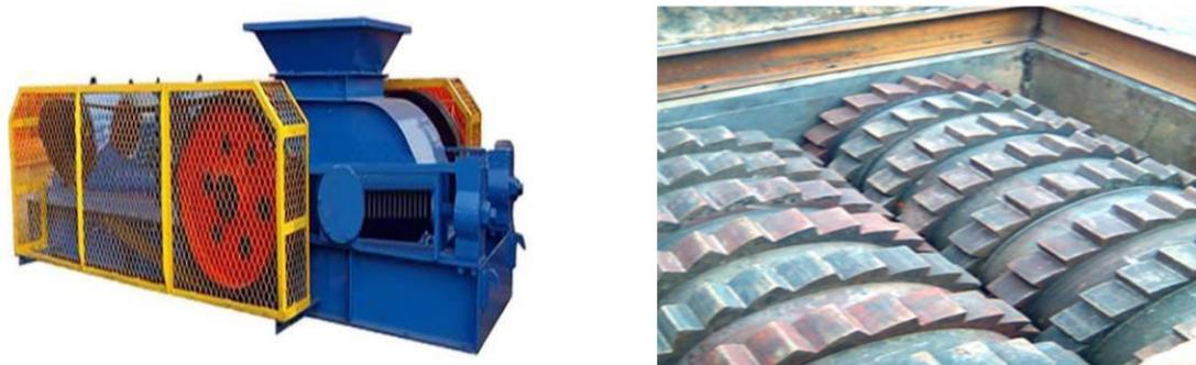
图6.8-8 双齿辊破碎机及其内部图
