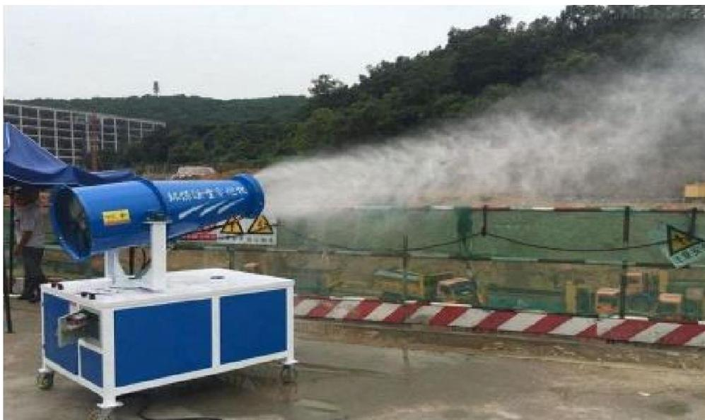
图7.3-1 强雾化水汽喷射装置
