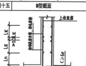
图二十一 柱变截面处纵筋构造三
