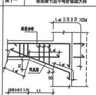
图九 吊钩配筋大样
