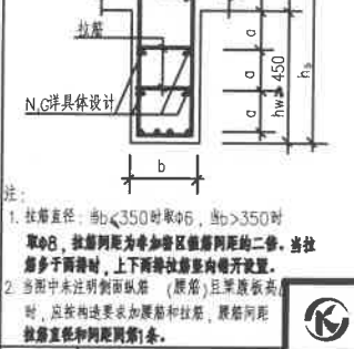
图十一 框架梁节点中弯折锚固大样
