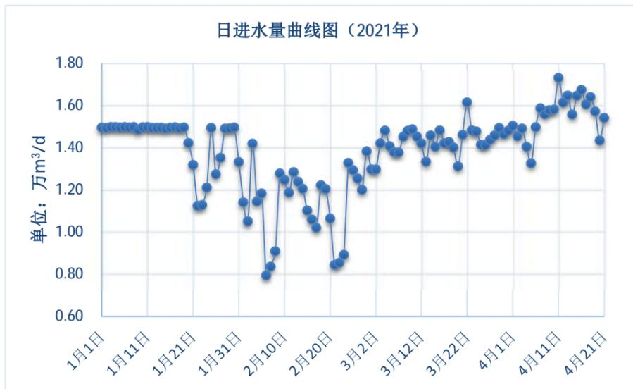
图 1.9-2 西区污水厂日进水量变化曲线图
