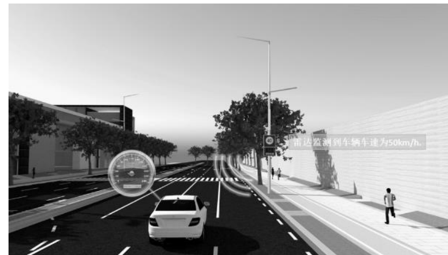
动态限速管理系统前端示意图
