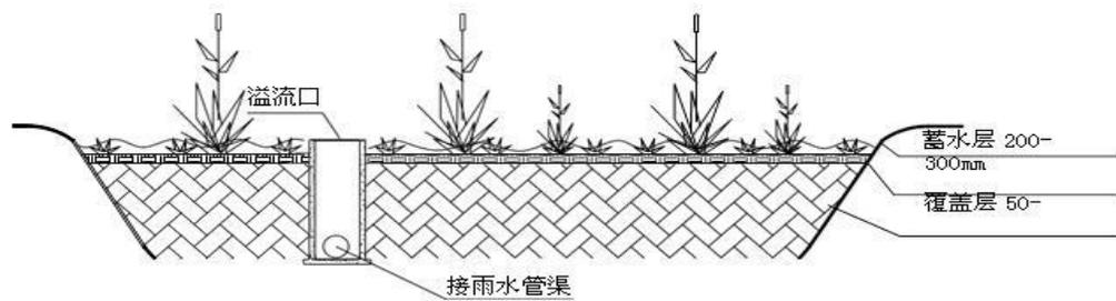
简易型生物滞留设施典型构造示意图
